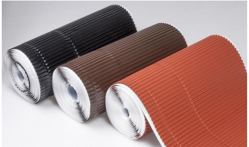
Aluflex® es ist ein vollflächig selbstklebendes Abdichtungsband aus profiliertem farbeschichteten Aluminium. Aluflex® es besitzt zwei Sollknickstellen, ca. 35 mm und 115 mm vom Rand. Diese asymmetrische Vorbereitung des Materials ermöglicht nach dem passgenauen Abschneiden des benötigten Materials ein optimales Anbringen. Zur optimalen Verarbeitung ist die Kleberbeschichtung mit einer reißfesten, geteilten und überlappenden Kunststoffolie abgedeckt.
