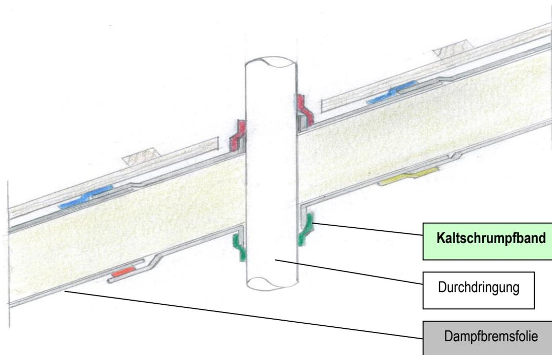
Bei Verwendung zur Abdichtung gegen Wasser ist die Möglichkeit von stehendem Wasser auf dem Dichtband auszuschließen. Kaltschrumpfband ist für den Innenbereich gedacht, für den Außenbereich empfehlen wir unsere Alu- oder Bleibutylbänder.
